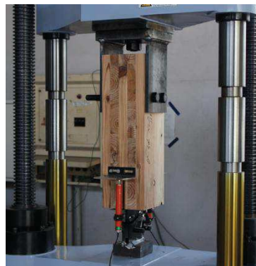
図4 CLT 接合部の強度試験 (中島昌一氏写真提供)
