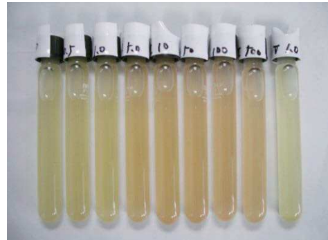
図2 三価ヒ素の検出 左から順に、非添加、0.5, 1.0, 5.0, 10, 50, 100, 500 \mu\text{g As(III)/L} 。右端は 1.0 \mu\text{g As(V)/L}
