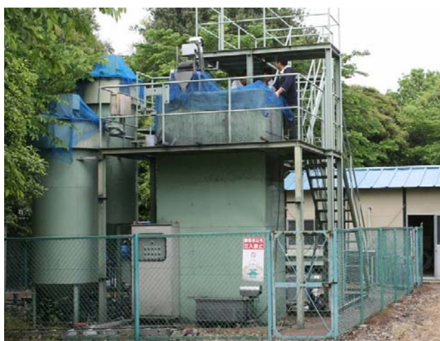
磁化活性汚泥法の下水処理パイロットプラント
