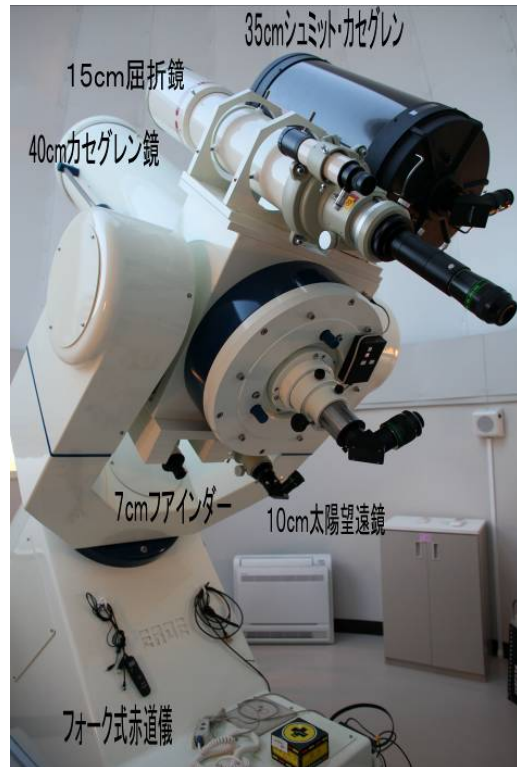
写真3. 導入された天体観測システム
