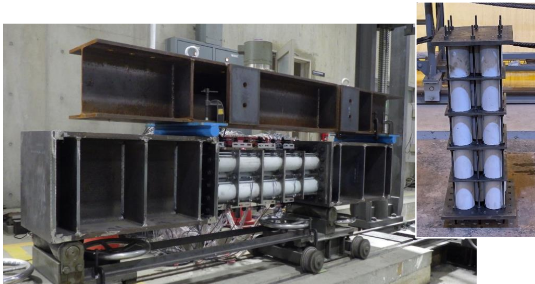
図 4 : CCC 柱部材の耐震性評価試験
