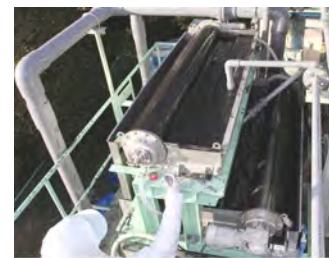
図3. 200m 3 /日を目指す実用磁気分離装置の開発
