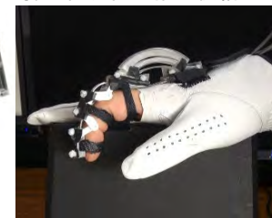
図3 良好な手指関節動作の支援装置
