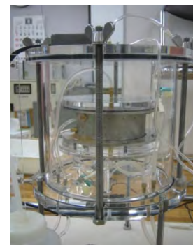
写真3 透水性試験器
