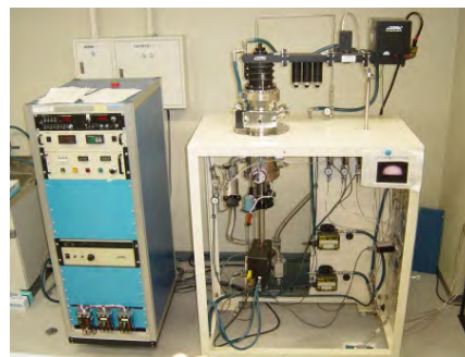
図2. ダイヤモンドの人工合成装置
