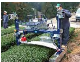
山間傾斜地で導入可能な、茶の収穫機械
