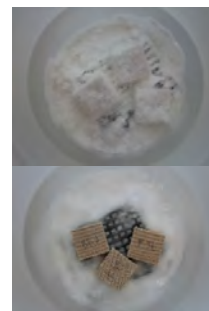
腐朽試験中の 木材試料
