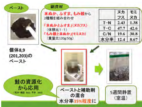
図3. 捕獲イノシシの内臓と米ぬか・もみ殻を用いたイノシシ資源化物の基幹技術
