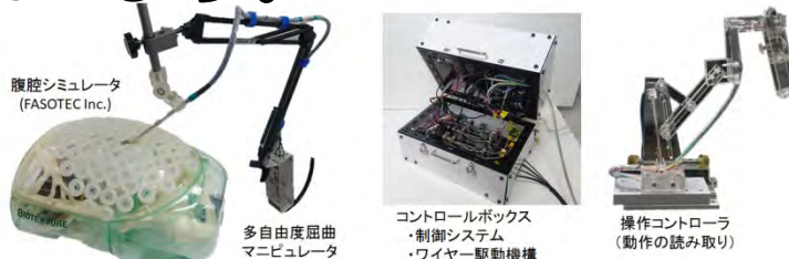
図2 腹腔鏡手術支援用屈曲マニピュレータ
