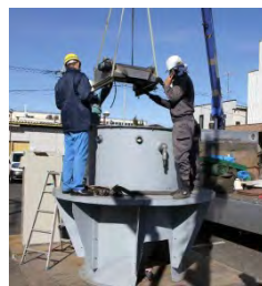
図2. 可搬型パイロットプラントによる食品排水処理試験
