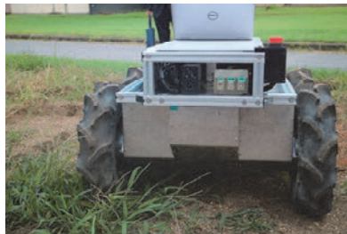
自走式イチゴ収穫ロボットの移動技術を活用して製品化し販売されている「農作物搬送ロボット」
