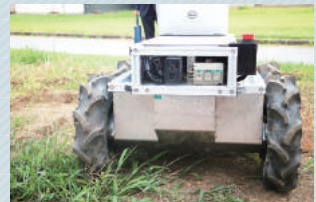
自走式イチゴ収穫ロボットの移動技術を活用して製品化し販売されている「農作物搬送ロボット」
